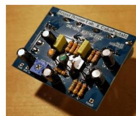
裏面に可変抵抗（VR1,VR2,VR3）、トグルスイッチ(SW1)は基板裏面に配置します。（表面からハンダ付け）
